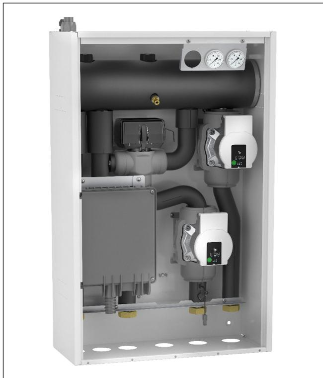
Il kit 2 zone per abbinamento a MAGIS PRO 12-14-16 V2 è composto dal telaio, dal collettore idraulico aperto, da elettropompe a basso consumo elettrico, valvola tre vie miscelatrice, tubi e raccordi idraulici e termometri per la lettura delle temperature. I circolatori inseriti nel kit, hanno la particolarità di essere molto elastici anche grazie alle curve di funzionamento che possono essere pre-impostate.
